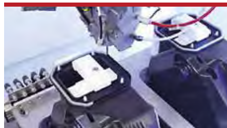
Aufgrund der werkzeuglosen Applikation sind PUR-Dichtungen im FIPFG-Verfahren eine kostengünstige Alternative für Bauteile mit komplexen Dichtungsgeometrien (Bild: Pöppelmann K-Tech)
