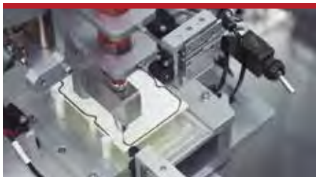
CNC-gesteuerte Dosierung eines Flüssigdichtmittels (Bild: Three Bond GmbH)
