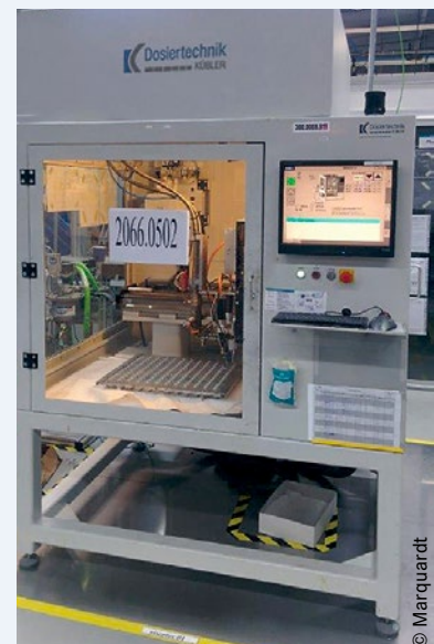
Bild 3: An seinem tunesischen Standort produziert Marquardt eine Vielfalt von Schaltern und mechatronischen Systemen. Derzeit befinden sich dort drei der flexibel konfigurierbaren Dosiersysteme Dos.Flex im Drei-Schichtbetrieb im Einsatz (links). Die rechte Aufnahme zeigt eine Anlage frontal mit Tray.
