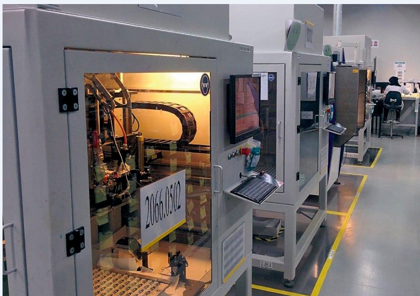
Bild 3: An seinem tunesischen Standort produziert Marquardt eine Vielfalt von Schaltern und mechatronischen Systemen. Derzeit befinden sich dort drei der flexibel konfigurierbaren Dosiersysteme Dos.Flex im Drei-Schichtbetrieb im Einsatz (links). Die rechte Aufnahme zeigt eine Anlage frontal mit Tray.
